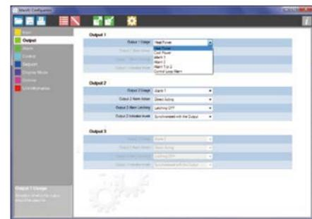
每个参数显示当前设定值, 可通过下拉菜单或直接输入数值进行更改。设置范围显示。帮助文档用于软件操作指导。
