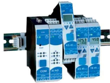
TB45 系列控制器，结构紧凑，宽度仅为 22.5mm，限值控制器通常用于设备的超温或超压保护，报警后会自锁，必须人工手动复位，面板上提供手动复位按钮
