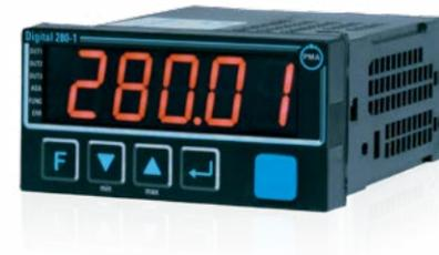
Digital 280-1 是高精度的 5 位大字符数显表，内置变送器电源，支持自定义线性化输入，具有去皮 / 峰值记录等功能，也可用位式控制或连续的 PID 控制器，广泛用于工业炉，燃烧器，锅炉，称重，塑料等行业
