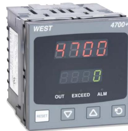
英国 West 的 Plus 系列温控表以其友好的用户界面、强大的技术功能以及灵活的现场配置广受用户赞誉, 目前英国原装和天津组装可选, 限值控制器通常用于设备的超温或超压保护, 报警后会自锁, 必须人工手动复位, 面板上提供手动复位按钮
