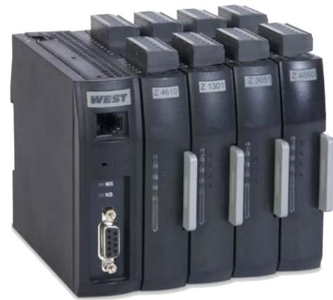
MLC9000+ 安装在面板之后的导轨上,用途广泛,即可独立运行也可作为 PLC 的从站使用。英国原装进口,温控效果超过 PLC,解决了“单表还是集成控制”的两难问题。
