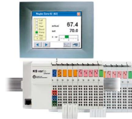
KS Vario 的操作面板, 5.7 寸触屏, 已经预先编好程序, 可以和 KS Vario 直接连接 (仅限 RS232/RS485 Modbus). (非必须, 用户也可选择第三方的触摸屏)
