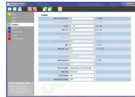
侧边索引栏用于方便切换参数。顶部任务栏导航图标, 包含主要功能选项。
