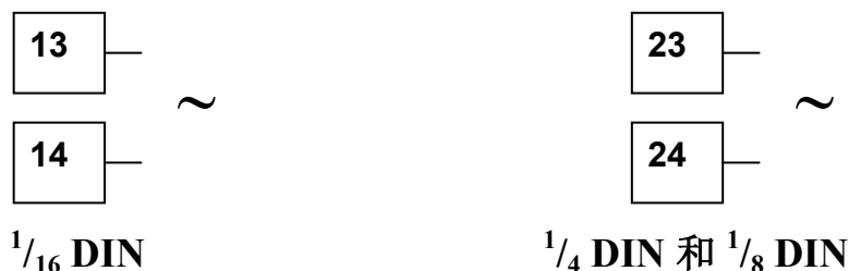
图 24 扩展槽 2 - Triac 三端双向可控硅开关元件
