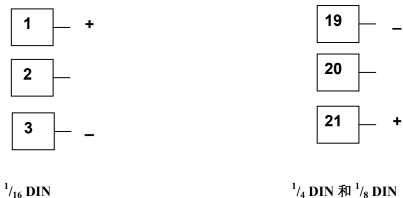
图 20 扩展槽 1 - Triac 三端双向可控硅开关元件
